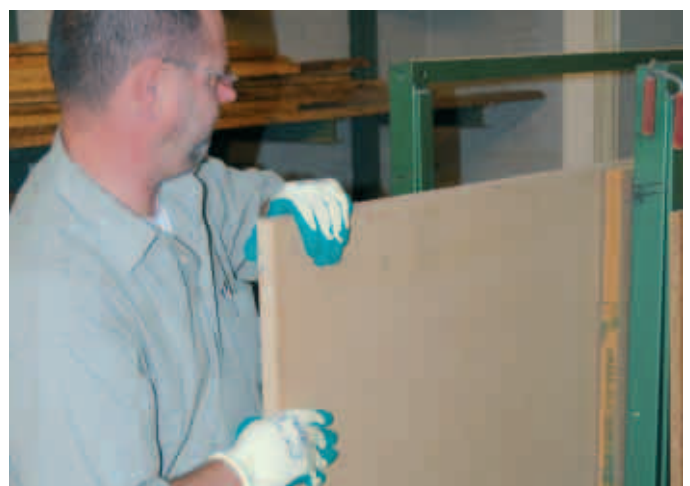
Handschuhe mit rutschhemmender Beschichtung und guter Griffigkeit
