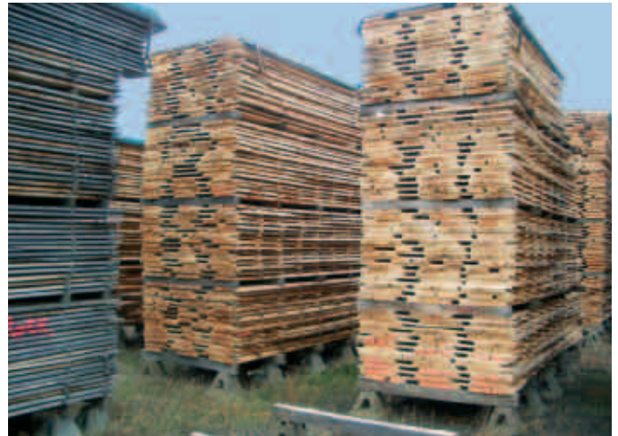
Zum Trocknen einzeln stehende Buchenholzpakete mit Höhe : Breite von höchstens 3 : 1
