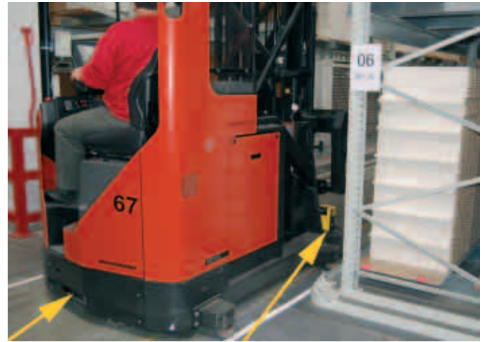
Laserscanner an Schmalgangstapler
