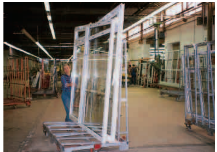
Transport von Fensterteilen in verfahrbaren Gestellen, Sicherung mit Gurten
