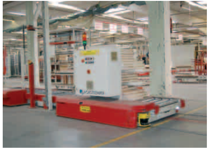
Längschiebewagen mit Laserscanner
