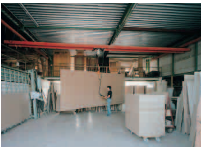
Transport mittels Brückenkran und Greifklemme
