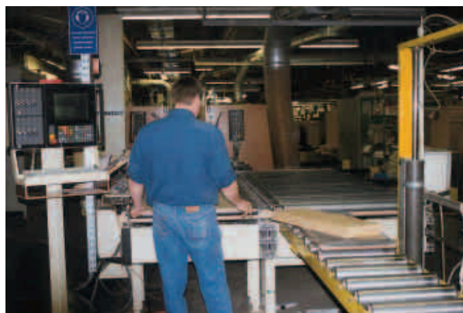
Anlieferung der Werkstücke über höhenverstellbare Rollenbahnen
