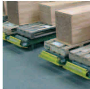
Ablaufsicherungen an Rollenbahnen
