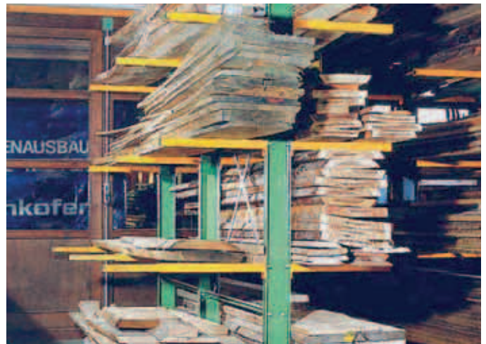
Kragarmregal (mit Teleskoparmen für Schnittholz)
