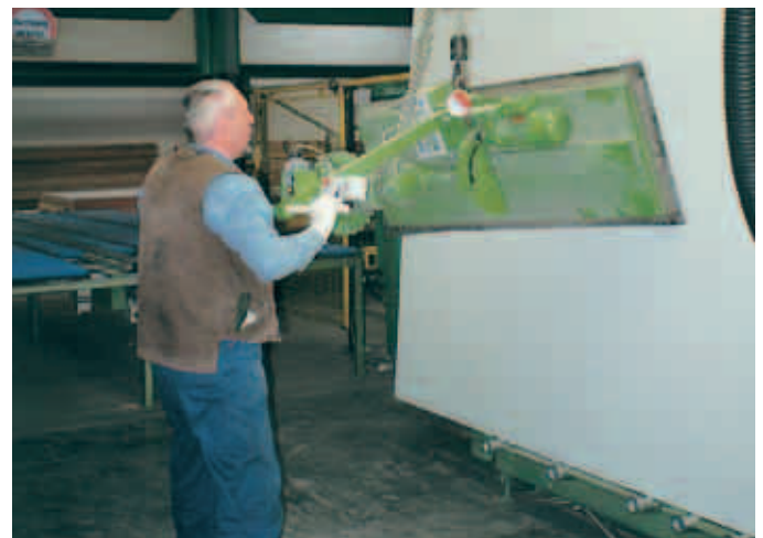
Beschickung einer Vertikalplattensäge mittels Vakuumheber
