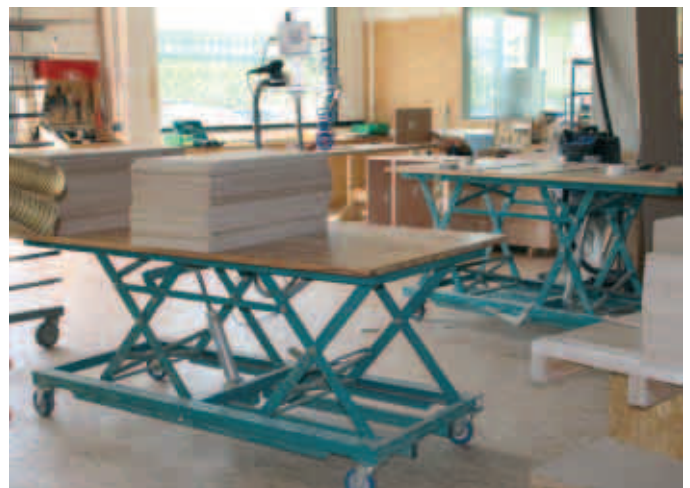
Transporthubwagen mit Höhenverstellung
