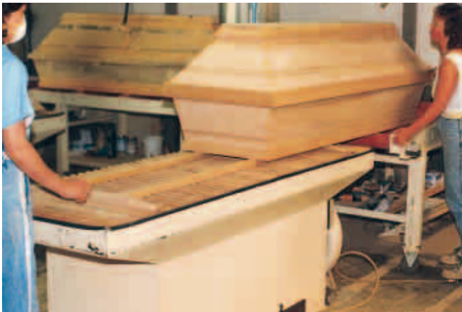
Anlieferung der Werkstücke über höhengleiche Rollenbahnen auf Schleiftische
