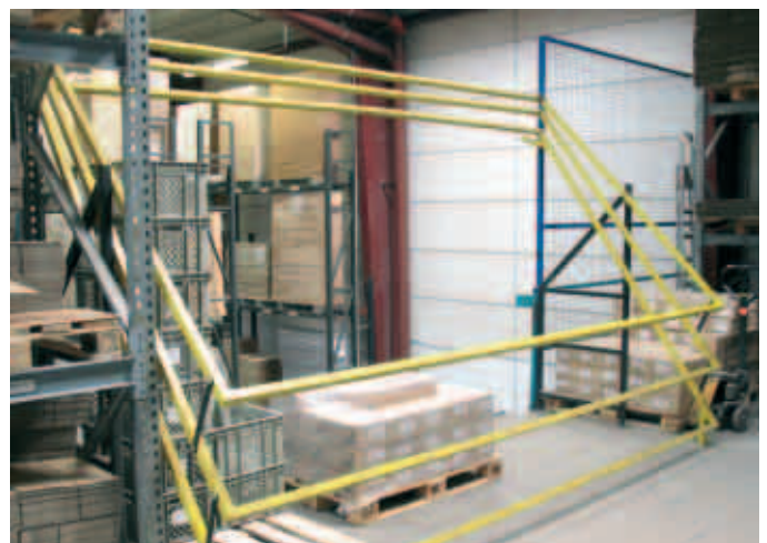
Schleusengeländer – Stapler kann die Last aufnehmen, Geländer zur Lagerbühne geschlossen
