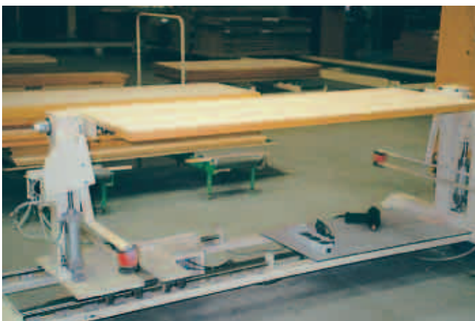
Wendeeinrichtung zur Türenmontage – manuelles Heben entfällt
