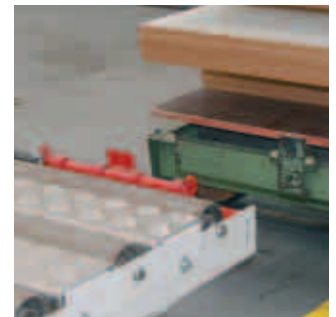
Ablaufsicherungen an Rollenbahnen
