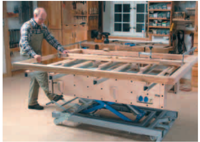
Montagetisch, höhenverstellbar, auch zum Transport geeignet
