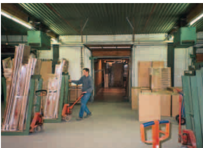
Abtransport kommissionierter Ware auf Handhubwagen
