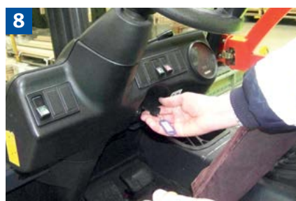
Gabelstapler erst verlassen, wenn der Antrieb stillgesetzt, die Feststellbremse angezogen, die Gabeln auf den Boden abgesenkt und der Schlüssel abgezogen ist.
