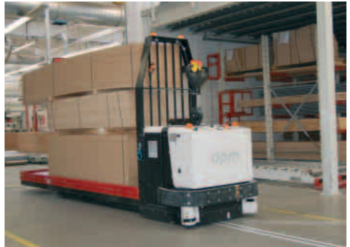
Fahrerloses Transportsystem mit Laserscannern
