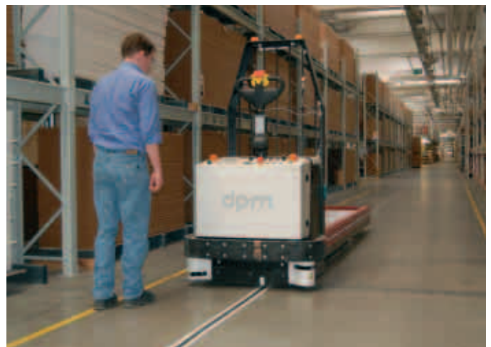
Fahrerloses Transportsystem mit Laserscannern
