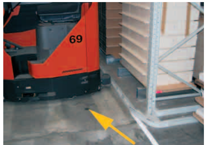
Gangendesicherung – Reduzierung der Fahrgeschwindigkeit
