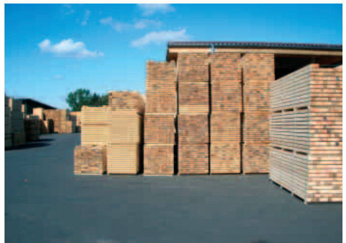
Pyramidenförmig aneinandergesetzte Bretterpakete bis Höhe : Breite = 4 : 1
