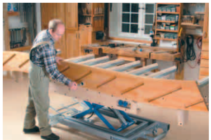
Höhenverstellbarer und verfahrbarer Montagetisch mit Energieanschluss
