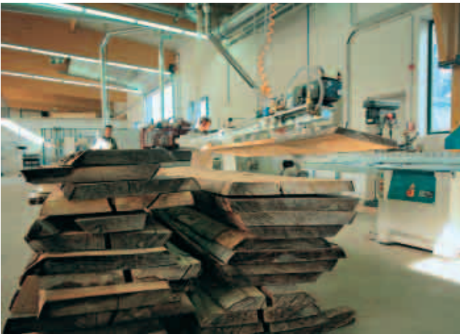
Vakuumheber für Schnittholz
