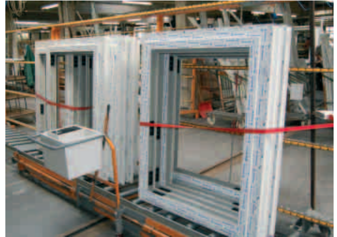
Transportwagen für Fenster und Türelemente, Sicherung mit Gurten
