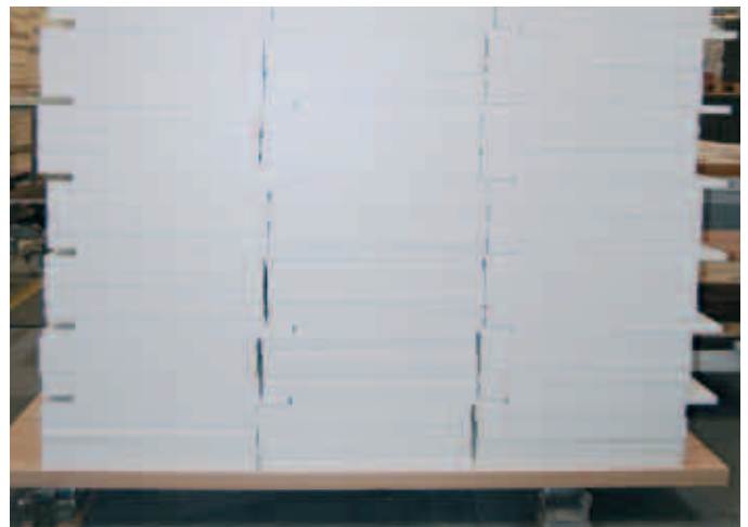
Sicherung gegen Umfallen durch versetzte Platten (Stapeln im Verbund). Dadurch können auch kleine Plattenformate hoch gestapelt werden.
