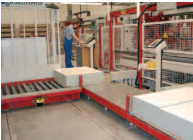
Querverschiebewagen mit Laserscanner
