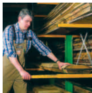
Kragarmregal (mit Teleskoparmen für Schnittholz)
