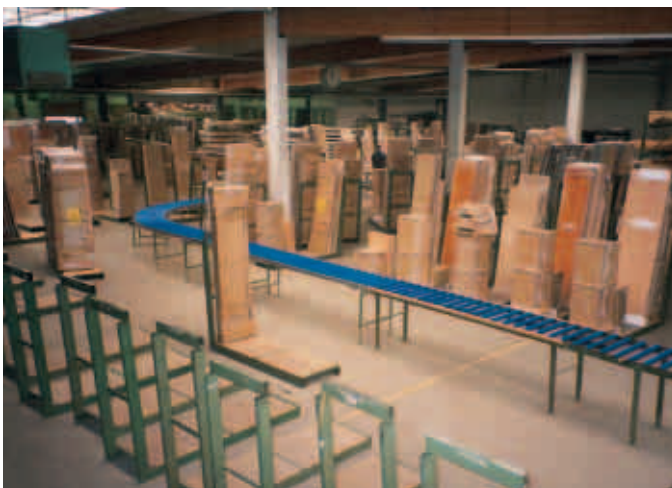
Rollenbahn im Kommissionierbereich
