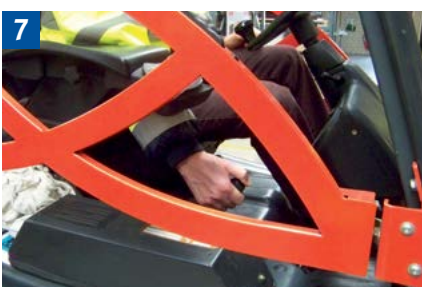
Vor Verlassen des Flurförderzeuges Feststellbremse anziehen und Gabeln absenken. Auf geneigten Flächen zusätzlich durch Unterlegkeile das Wegrollen verhindern.
