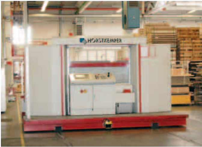
Querverschiebewagen mit Laserscanner (Sicherheitsabstand von 0,5 m ist eingehalten)
