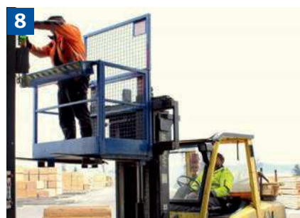
Instandhaltungsarbeiten mit Gabelstapler und Arbeitsbühne
