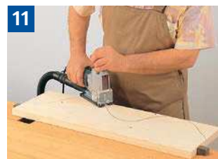
11 Sägen geschweiften Werkstücke.
