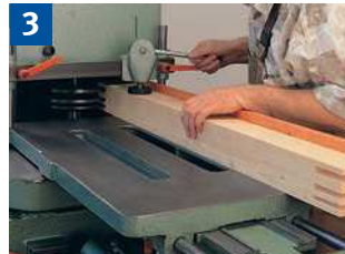
3 Handvorschub = Arbeiten mit dem Schiebeshlitten.
