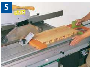
5 Vorrichtung und Handhaltung beim Besäumen.
