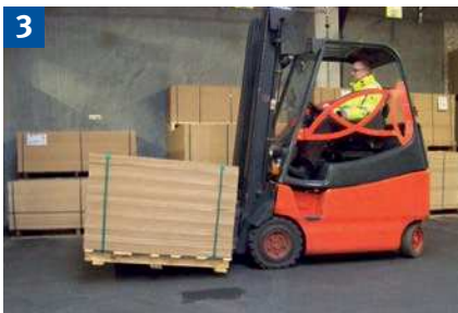
Last am Gabelrücken anlegen, Hubmast nach hinten neigen. Gabelzinken gleichmäßig belasten, in niedrigster Stellung verfahren.
