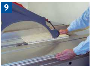
9 Schutzvorrichtung und Handhaltung beim Fälen.
