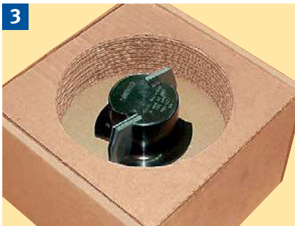
Werkzeuge mit Hartmetallwechscheln immer in der Originalverpackung transportieren.
