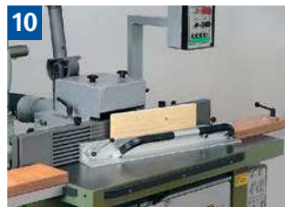
10 Einsetzfräsen kleiner Werkstücke mit Spannlade und Rückschlagsicherung.
