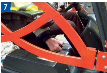
Vor Verlassen des Flurförderzeugs Feststellbremse anziehen und Gabeln absenken. Auf geneigten Flächen zusätzlich durch Unterlegkeile das Wegrollen verhindern.
