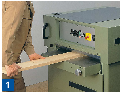
Hobeln breiter Werkstücke. Durch mehrere Hobelvorgänge das Endmaß herstellen.
