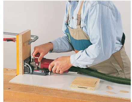
Werkstück bei stehender Bearbeitung durch Stützwinkel sichern.
