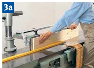
3a Fügen breiter Werkstücke mit Fügeleiste und Klappenschutz.
