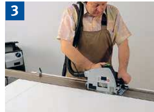
3 Einsetsägen mit Tauchkreissäge und Führungsschiene mit Anschlagnocken (als Rückschlagsicherung).
