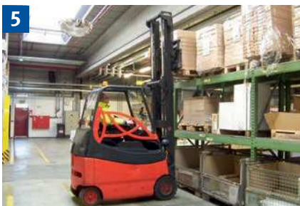
Mit hochgestellter Last nur zum Auf- und Absetzen verfahren. Hubgerüst nur über Stapelfläche nach vorn neigen.
