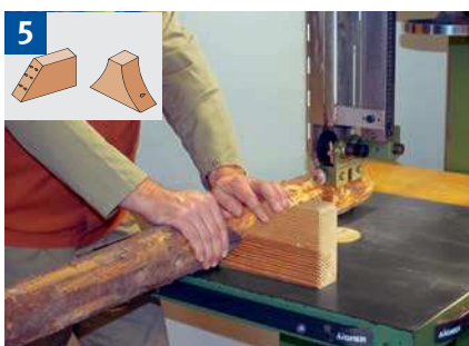
Quersägen von Rundholz mit Keilstütze.
