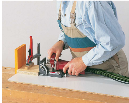
Werkstück bei liegender Bearbeitung auf eine ebene Unterlage auflegen.
