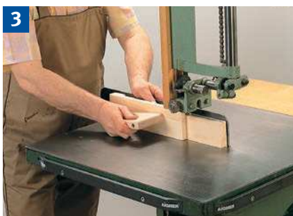
Auftrennen am Anschlag mit Zuführlade.
