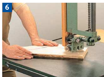
Handhaltung beim Herstellen geschweifeter Werkstücke.
