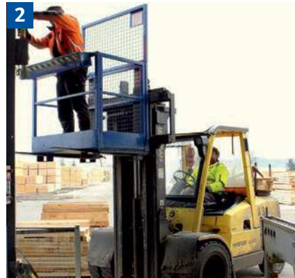
2 Instandhaltungsarbeiten mit Gabelstapler und Arbeitsbühne.
