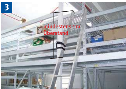
Die Leiter muss die Austrittsstelle mindestens um 1 m überragen.
