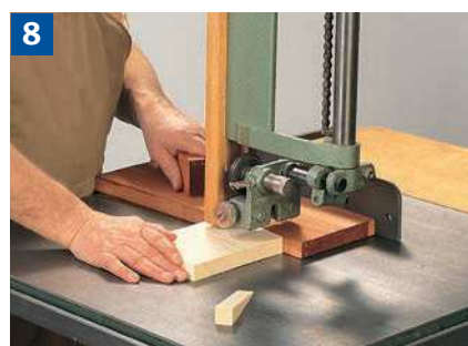
Sägen von Keilen mit Keilschneidlade.
