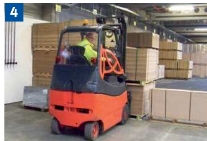
Niemals ohne Sicht fahren. Ausnahmeweise beim Transport hoher Lasten rückwärtsfahren oder Einweiser zur Hilfe nehmen.
