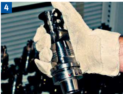
Beim Ein- und Ausbauen von Werkzeugen mit Hartmetallwechscheln die Hände mit Handschuhen oder einem Lappen schützen.
