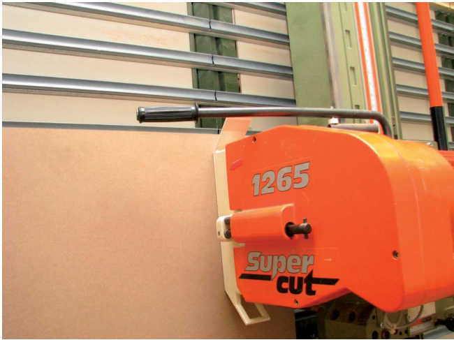
Selbsttätig schließende Sägeblattverkleidung
