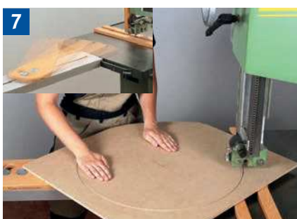
Vorrichtung und Handhaltung beim Herstellen kreisförmiger Werkstücke.
