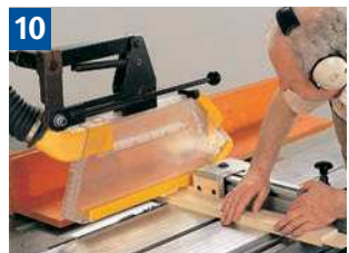
10 Schutzvorrichtung und Handhaltung beim Absetzen von Zapfen.
