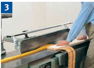
3 Abrichten breiter Werkstücke mit Fügeleiste und Klappenschutz.
