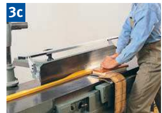
3c Abrichten kurzer Werkstücke mit Fügeleiste, Klappenschutz und Zuführlade.
