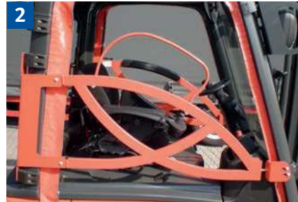
Fahrerückhalteinrichtung (z. B. Fahrersitzgurt oder Bügeltür) bei jeder Fahrt benutzen.
