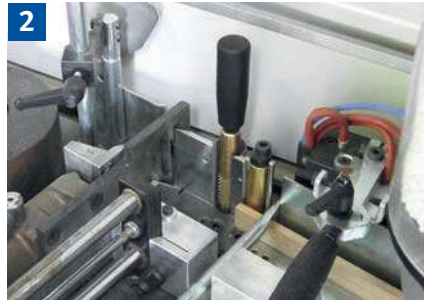
2 Gefahrstellen der Stachelwalze
