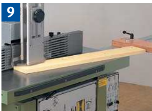
9 Einsetzfräsen großer Werkstücke mit Rückschlagsicherung.
