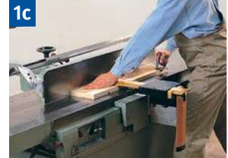
1c Abrichten kurzer Werkstücke mit Schutzbrücke und Schiebeholz.
