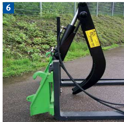
6 Gabelstapler mit Zangengreifer zum Transport von Rundholz.
