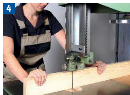
Quersägen von hochkant stehenden Werkstücken mit Anlage am Maschinenständer.
