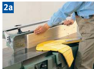
2a Fügen breiter Werkstücke mit Gliederschwingschutz.
