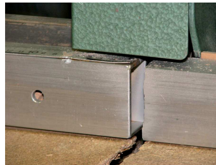
Durchtrittsöffnung für das Sägeblatt im Anschlag (max. Breite 8 mm)
