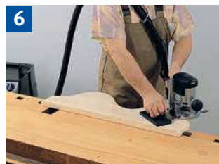
6 Bearbeiten von Werkstückkanten mit der Handoberfräsmaschine.
