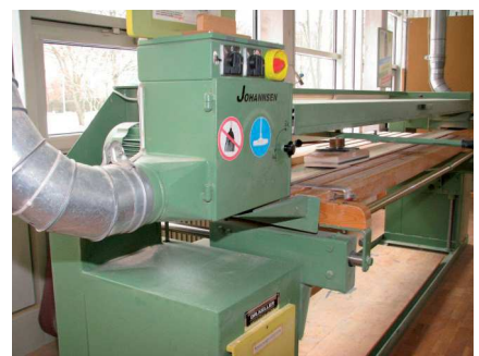
Begrenzung des Tischfahrbereiches um Schnittverletzungen durch das Schleifband zu vermeiden
