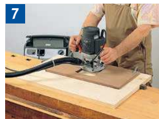
7 Einsatz der Handoberfräsmaschine mit Schablone.
