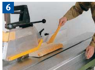
6 Sägen schmaler Werkstücke mit Schiebestock.
