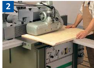
2 Handvorschub = Arbeiten mit dem Vorschubapparat.
