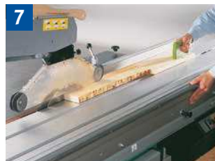
7 Sägen von Leisten mit Schiebeh Holz.
