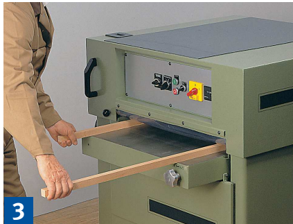
Hobeln schmaler Werkstücke. Bei starren Einzugsrollen und Druckbalken maximal zwei Werkstücke gleichzeitig bearbeiten.
