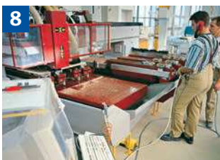
8 Mechanischer Vorschub = z. B. Arbeiten mit CNC Bearbeitungszentrum.
