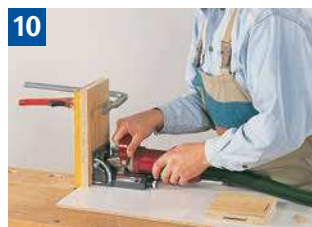
10 Einfräsen von Nuten mit Stützwinkel.
