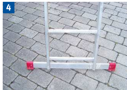
Anlegeleitern gegen Ausgleiten, Umfallen, Umkanten, Abrutschen und Einsinken sichern, z. B. durch Fußverbreiterung
