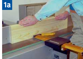
1a Fügen breiter Werkstücke mit Schutzbrücke.
