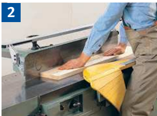
2 Abrichten breiter Werkstücke mit Gliederschwingschutz.
