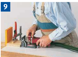
9 Einfräsen von Nuten, kleine Werkstücke festspannen.
