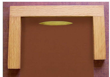
Detailansicht einer Schablone zum Harzgallenfräsen.
