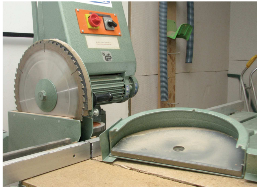
Sägeblattverkleidung mit schallabsorbierender Auskleidung
