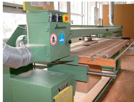
Begrenzung des Tischfahrbereiches um Schnittverletzungen durch das Schleifband zu vermeiden
