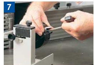
7 Lösen der Spannschrauben mit vorgegebenem Werkzeug (Imbusschlüssel).
