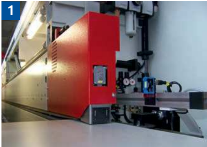
1 Werkstückaufgabe gesichert, z. B. durch eine elektrisch verriegelte Pendelklappe
