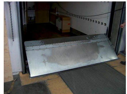
Ladebrücke an Koffer des Fahrzeuges anpassen
