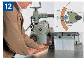
12 Fräsen von geschweiften Werkstücken mit Anlauftring, Bogenfräshaube und Vorschubapparat (nur 1 Rolle).
