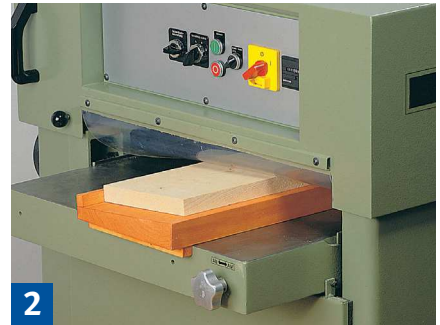
Hobeln mit Schablone. Bei nicht parallelen Flächen geeignete Schablonen verwenden.
