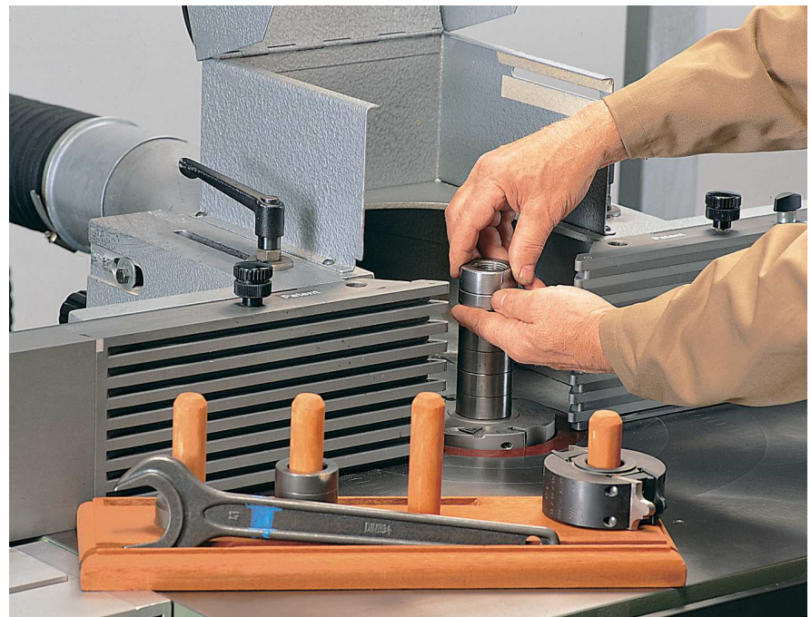
Rüsten einer Tischfräsmaschine mit Fräs Werkzeug
