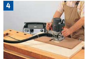
4 Handvorschub = Arbeiten mit Handmaschinen.
