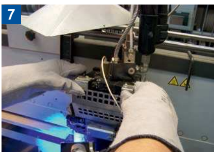
7 Bei Arbeiten an Leimbehältern Schutzhandschuhe tragen
