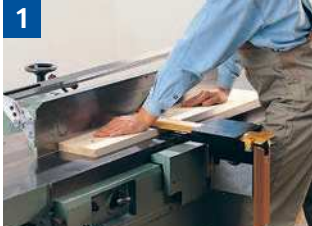
1 Abrichten breiter Werkstücke mit Schutzbrücke.
