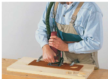
Beim Harzgallenausfräsen Maschine mit beiden Händen führen.
