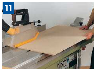
11 Schutzvorrichtungen und Handhaltung beim Einsetzsägen. Sägeblatt wird von unten nach oben durch das Werkstück angehoben.
